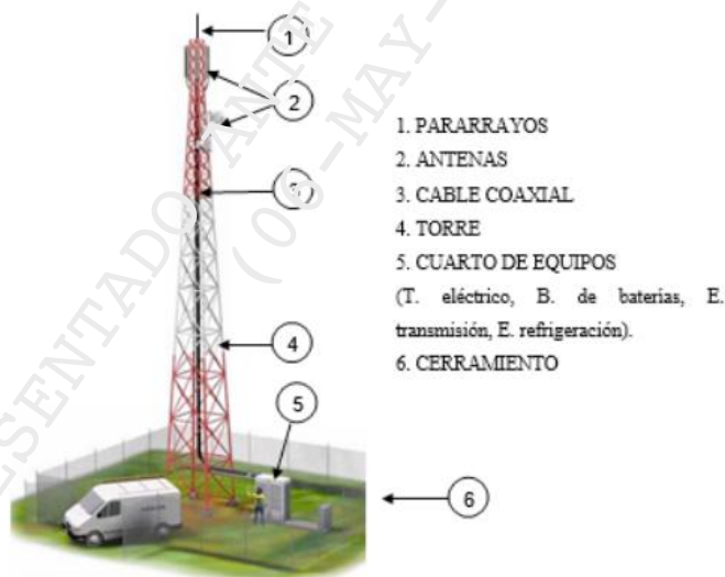
Figura 4. Componentes de una estación radioeléctrica
