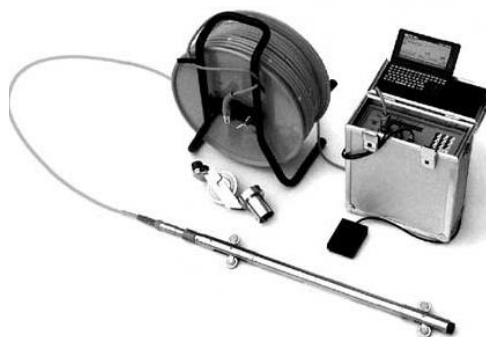
Fotografía 7. Instrumento Inclínómetros usado para el monitoreo del desplazamiento de los suelos.
